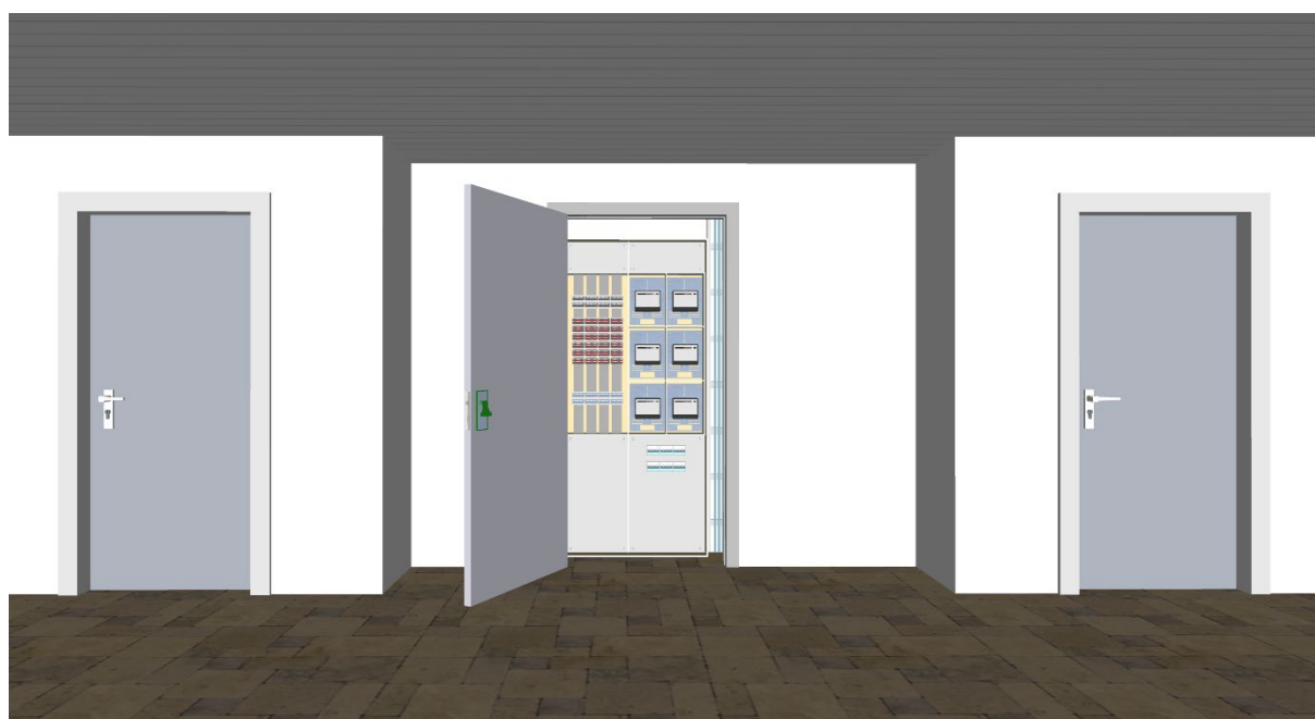
Figur 92 Eksempel på etasjefordeler i boligblokk - 6 målere
