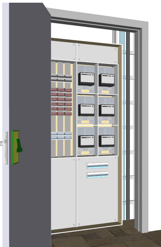
Figur 94 RT11093 - Etasjefordeler i boligblokk - i rømningsvei med branddør
