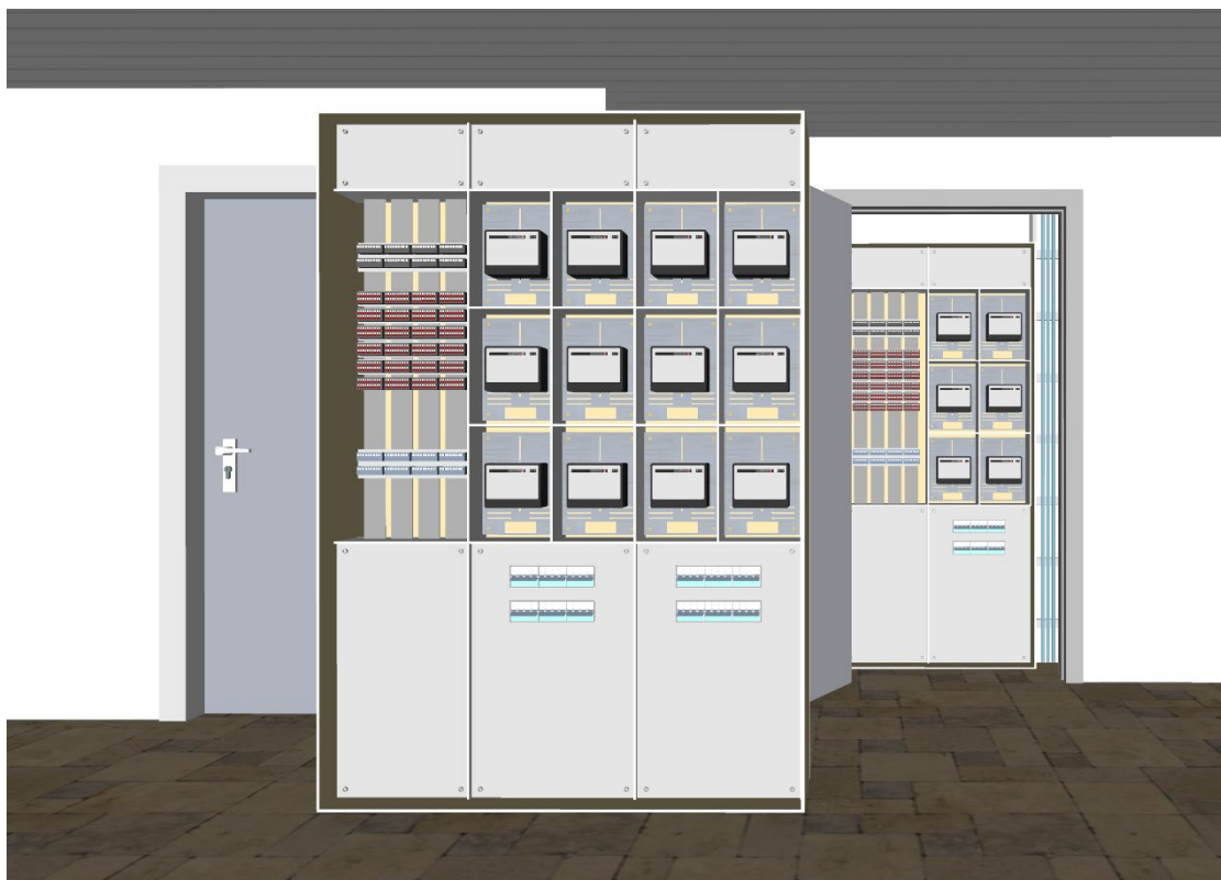
Figur 93 RT11192 - Eksempel på etasjefordeler i boligblokk - 12 målere
