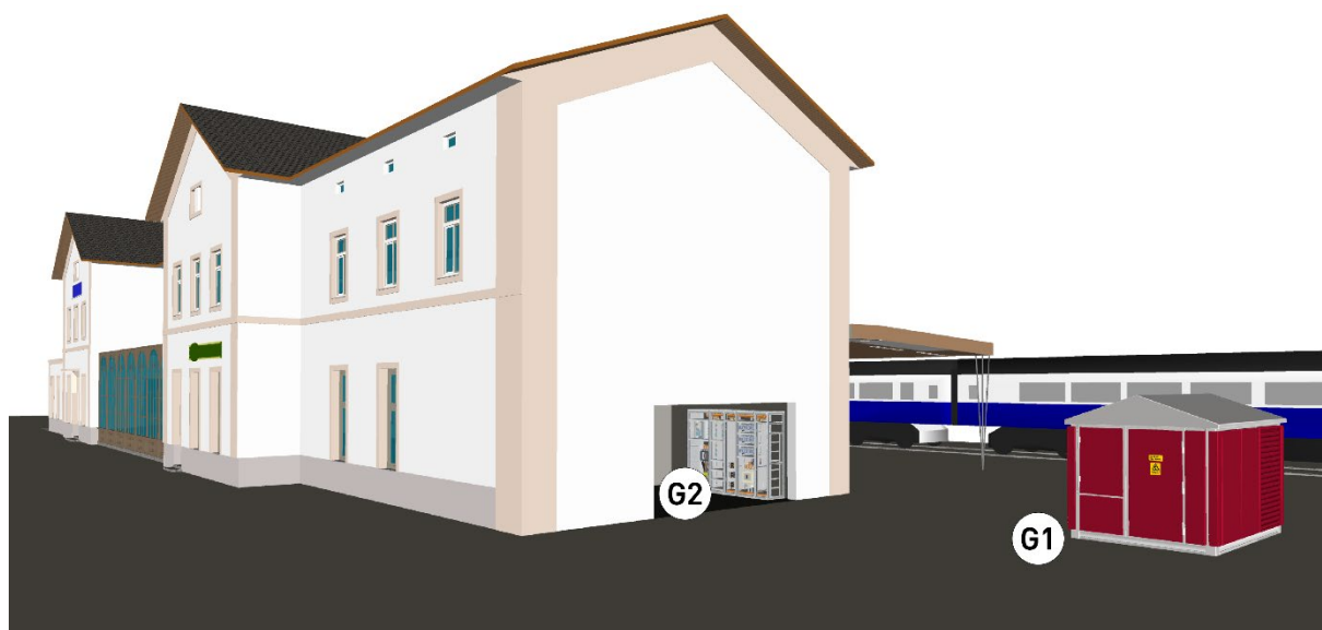
Figur 64 Illustrasjon på forsyning av hovedfordeling fra nettstasjon
