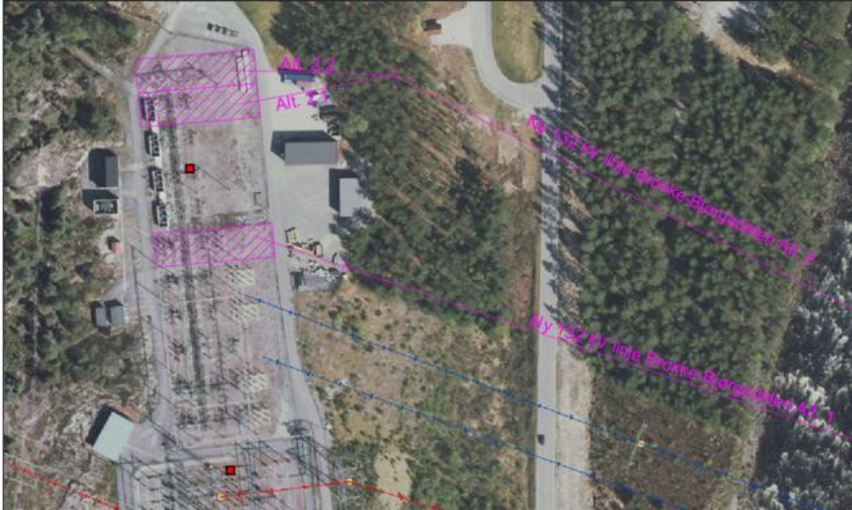
Figur 3 Situasjonsplan Brokke transformatorstasjon, med tre alternative innføringer.
